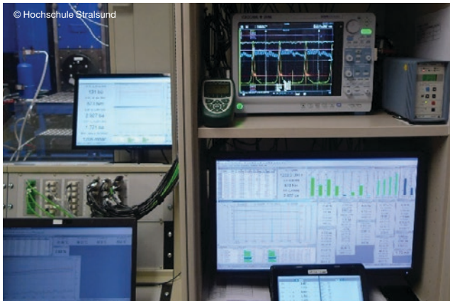
Abb. 3: ScopeCorder DL950 im Prüfstandsaufbau
