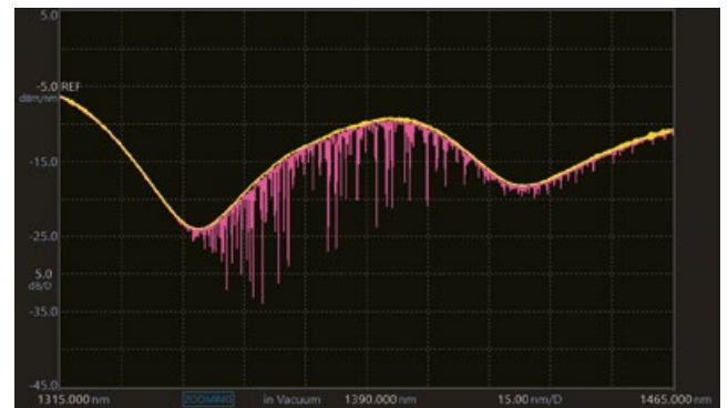
Abb. 6: Wasserabsorptionsspektren ohne, in gelb mit Air Purge
